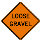
W8-7 LOOSE GRAVEL
