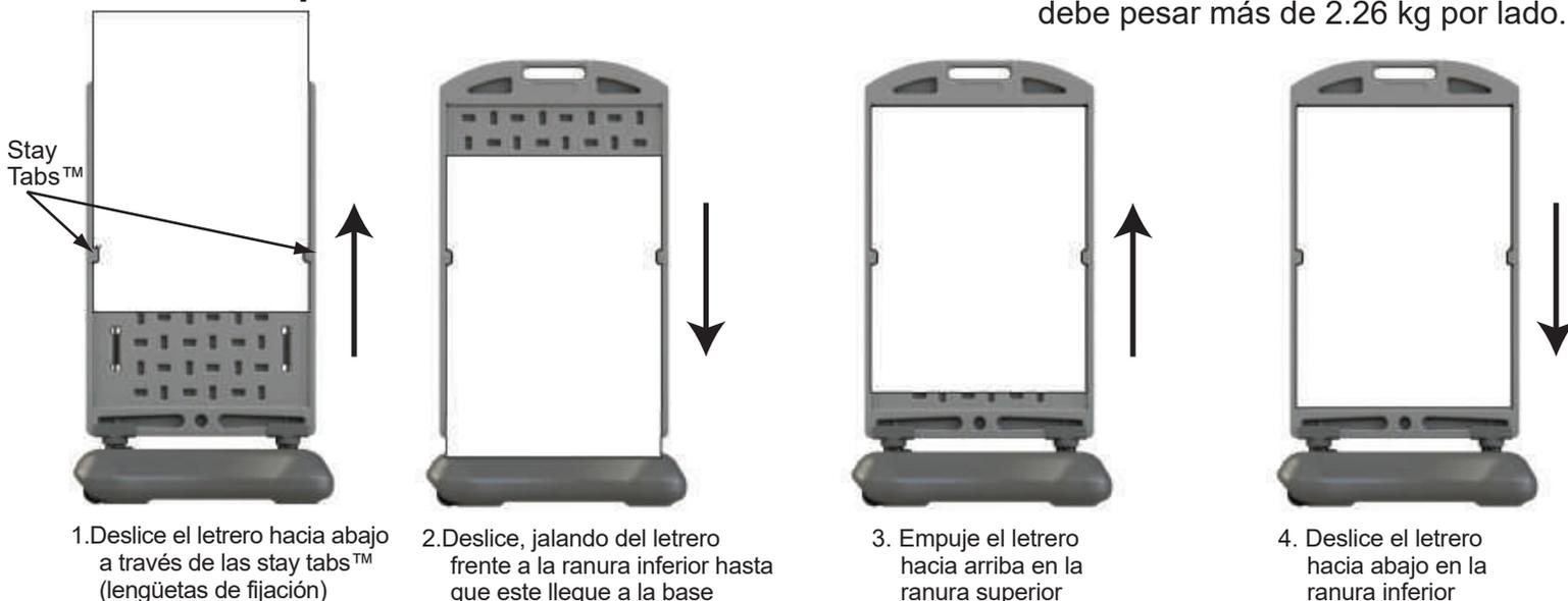
1. Deslice el letrero hacia abajo a través de las stay tabs™ (lengüetas de fijación)
